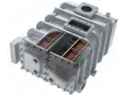
空気圧力損失をシェル&チューブ式と比べて1/5に、さらにバッケージ吐出空気温度を従来機より低減。ドライヤ等の後流機器の選定条件が緩和され、エネルギー損失を削減します。チューブ材質はステンレスを標準採用。高い耐腐食性能を発揮します。
