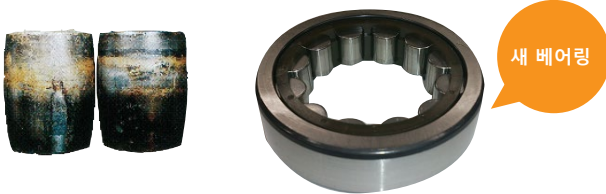
오일 부족으로 인한 윤활불량으로 전동면이 변색 용해된 상태
