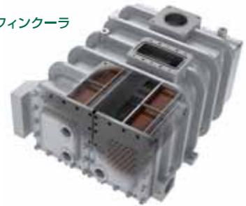
空気圧力損失をシェル&チューブ式と比べて1/5に、さらにパッケージ吐出空気温度を従来機より低減。ドライヤ等の後流機器の選定条件が緩和され、エネルギー消費を削減します。チューブ材質はステンレスを標準採用。高い耐腐食性能を発揮します。
