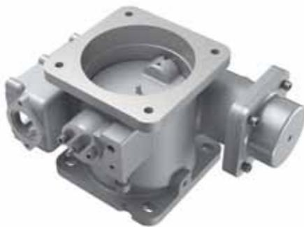
省エネロジック制御を可能にする、すぐれた応答性と耐久性を持つ空圧式の吸気調整弁。放風サイレンサの内蔵によりメンテナンス部品を削減しました。
