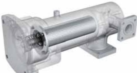
拡張型サイレンサと多孔板サイレンサの組み合わせにより、幅広い周波数帯域に減音効果を発揮。インバータ機の回転数制御により変化する騒音にも対応します。
